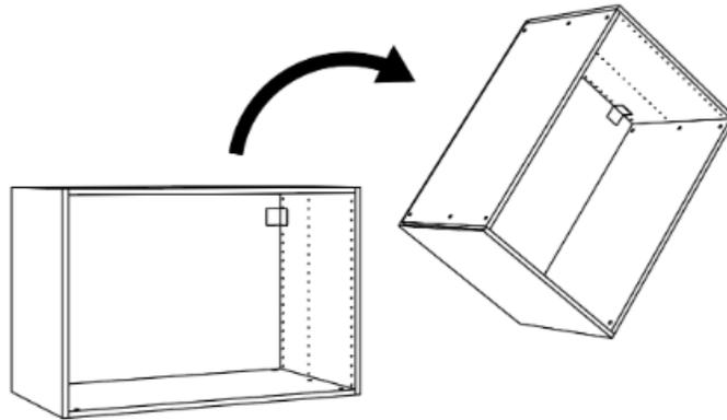
**Étape 03:** Les surmeubles sont vissés depuis la "nouvelle base" aux PAX inférieurs et également entre eux, pour obtenir une structure totalement compacte et solide.
