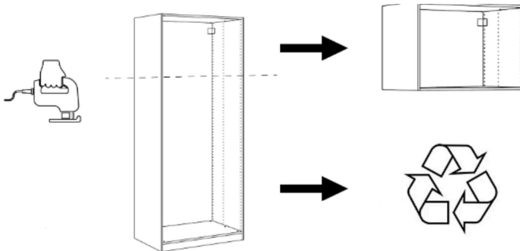
**Étape 02:** Une fois le PAX coupé, nous le retournerons, faisant de la couverture supérieure la base du surmeuble. De cette façon, la coupe de l'armoire sera dans la zone supérieure, et l'assemblage des deux coques sera plus propre et plus précis.
