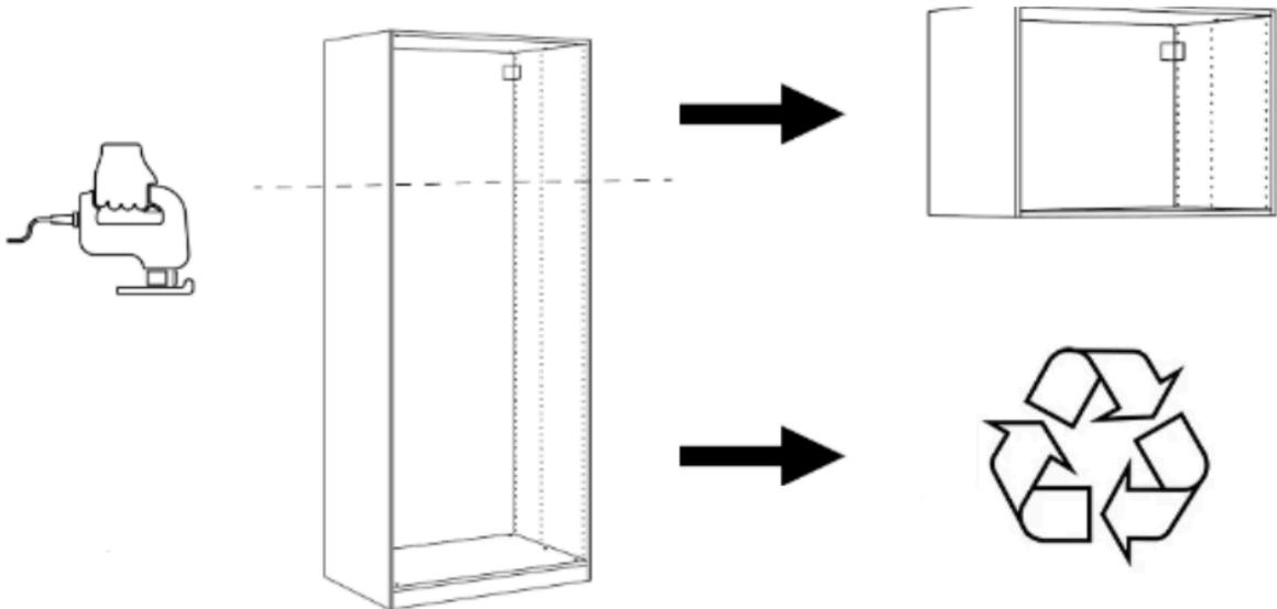
**Paso 02:** Una vez recortado el Pax, le daremos la vuelta, haciendo que la tapa superior sea la base del altillo. De esta manera, el corte del armario quedará en la zona superior y la unión de ambos cascos resultará más limpia y precisa.
