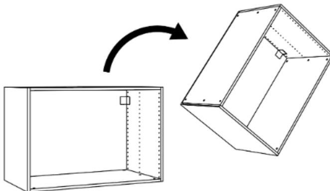
**Paso 03:** Los altillos se atornillan por la “nueva base” a los PAX inferiores y a su vez entre ellos, para poder conseguir una estructura totalmente compacta y sólida.
